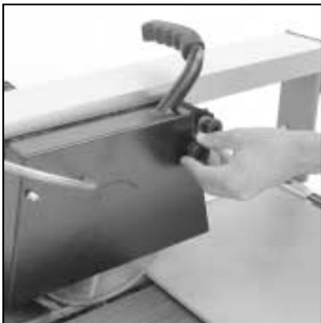
Blockieren Sie die Achse der Scheibe, indem Sie dem beiliegenden Schlüssel in die Öffnung der Achse stecken und die
