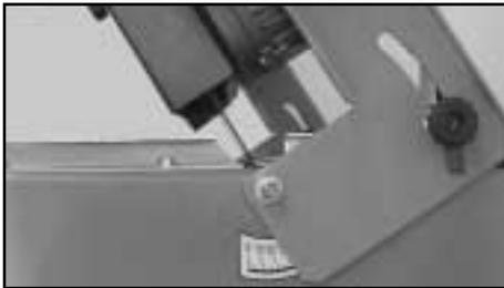
Der Schneidkopf dieser Maschine ist bis zu 45° schwenkbar. Daher können Jolly- schnitte mit Winkeln zwischen 45° und 90° durchgeführt werden.
