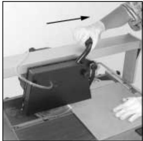
Die Maschine ist speziell für Schnitte mit wassergekühlten Diamantscheiben entworfen und hergestellt worden. Die Kühlung der Schneidscheibe erfolgt über einen geschlossenen, ständig fließenden Wasserkreislauf mit einer elektrischen Wasserpumpe. So kann die Pumpe, solange sie unter Wasser ist, bei normalen Bedingungen nicht heißlaufen.
