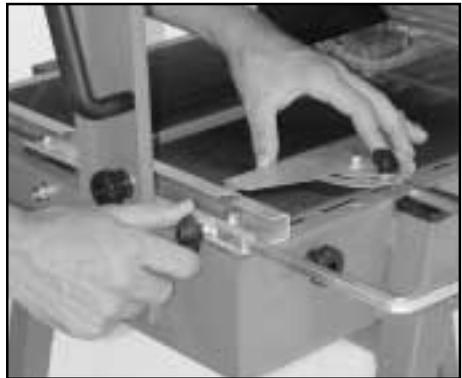
Wenn der Schneidkopf zu schnell bewegt wird, verbiegt sich die Trennscheibe, was zu einem ungleichmäßigen Schnitt und zur Beschädigung der Scheibe führt.
