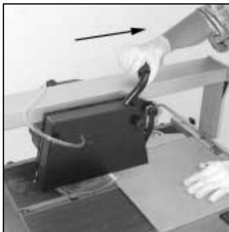
La macchina è stata realizzata per eseguire specificatamente tagli con dischi diamantati raffreddati ad acqua. Il raffreddamento del disco da taglio viene effettuato attraverso un circuito d'acqua chiuso e continuo, con una pompa elettrica. In questo modo la pompa, fino a quando è sott'acqua, non può riscaldarsi in condizioni normali. L'interruttore della macchina aziona contemporaneamente la pompa e il motore.
