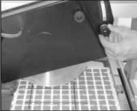
Legen Sie das Werkstück mit der Glasur nach unten auf die Auflagefläche und schneiden Sie die angezeichnete Linie, indem Sie die Scheibe erst nach unten und dann vorwärts und rückwärts bis zum gewünschten Punkt bewegen (Sie haben nun die erste Seite des Fensters geschnitten). Legen Sie das Werkstück erneut an und schneiden Sie die zum ersten Schnitt parallele Seite und dann die restlichen Seiten.
