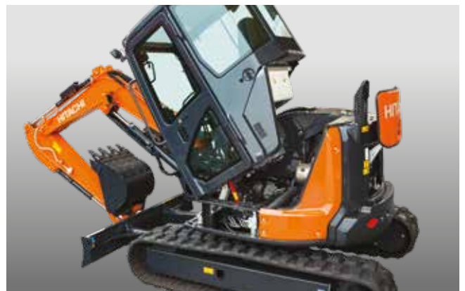
Il pavimento inclinabile consente un facile accesso al motore e alla valvola di controllo, per velocizzare la manutenzione.
