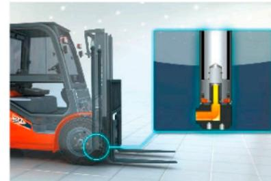
■ dispositivo tampone di abbassamento
